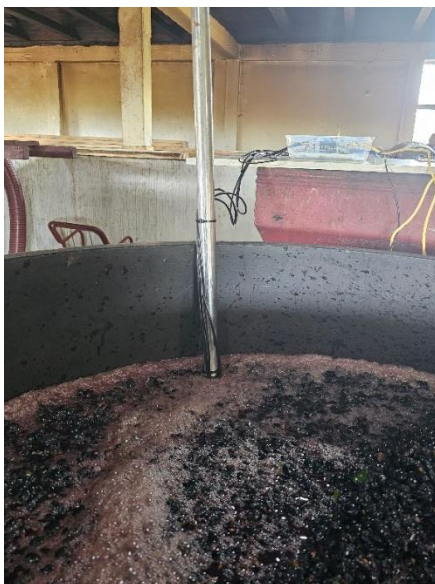
Slika 32. Inoks šipka sa fiksnim senzorima u fermentacionom sudu sa grožđanim kljukom
