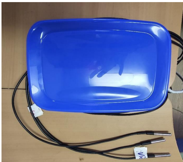
Slika 36. PVC kutija u koju je smješten mikrokontroler i razvojna pločica
