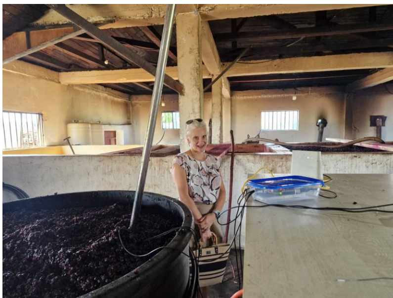
Slika 33. Fotografija predloženog IoT sistema za kontrolu temperature alkoholne fermentacije u vinskom podrumu
